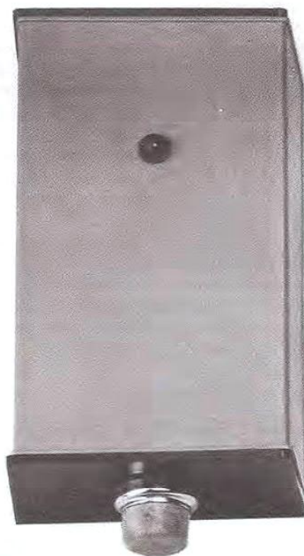
Fig. 11 Una volta chiusa l'elegante scatola plastica bicolore, dovreste fissarla alla parete della vostra stanza, tenendo la sonda rivelatrice rivolta verso il basso, come vedesi in questa foto. Come spiegato nell'articolo, non bisogna collocare tale sonda sopra ai fornelli, ma a una certa distanza da essi.
