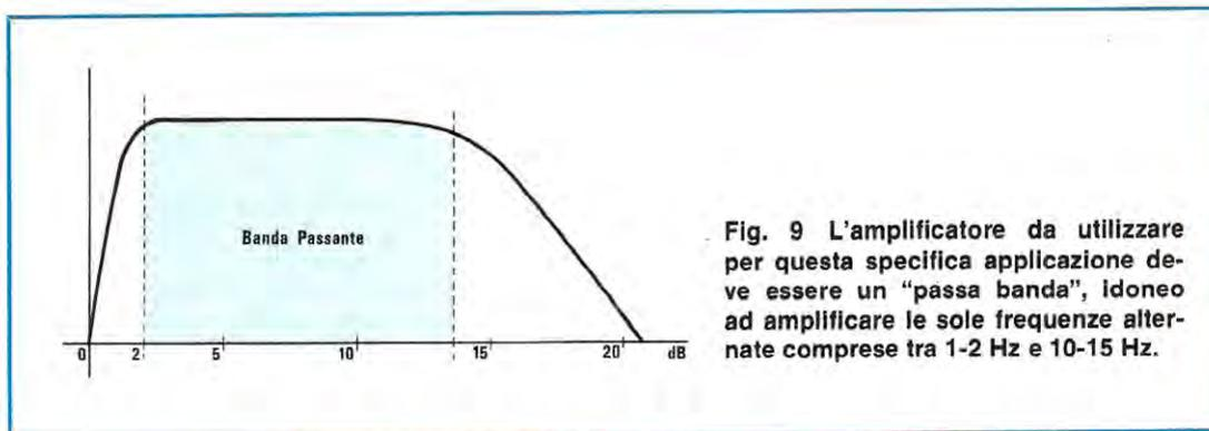
Fig. 9 L'amplificatore da utilizzare per questa specifica applicazione deve essere un "passa banda", idoneo ad amplificare le sole frequenze alterate comprese tra 1-2 Hz e 10-15 Hz.
