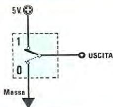
**Fig. 1** Per comprendere il significato dei due livelli logici 1 e 0 considerate il piedino di uscita dell'integrato come se fosse il terminale centrale di un semplice deviatore in grado commutarsi sulla tensione positiva oppure sulla massa.
