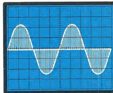
**Fig. 15** Il trimmer R46 ci servirà per ottenere la forma d'onda visibile in figura, cioè per fare in modo che le semionde negative e positive terminino al centro della linea di separazione.
