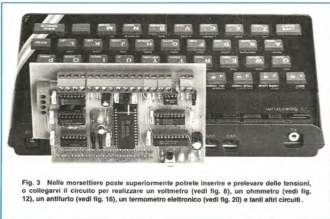
**Fig. 3** Nelle morsettiere poste superiormente potrete inserire e prelevare delle tensioni, o collegarvi il circuito per realizzare un voltmetro (vedi fig. 8), un ohmmetro (vedi fig. 12), un antifurto (vedi fig. 16), un termometro elettronico (vedi fig. 20) e tanti altri circuiti.
