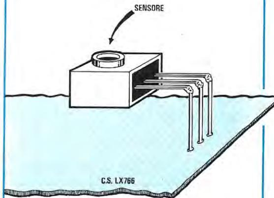
Fig. 15 Volendo utilizzare una parabola converrà montare il sensore in posizione orizzontale e per far ciò bisognerà saldare sul circuito stampato tre lunghi terminali, in modo che il corpo del sensore si appoggi perfettamente sul condensatore elettrolitico C7.
