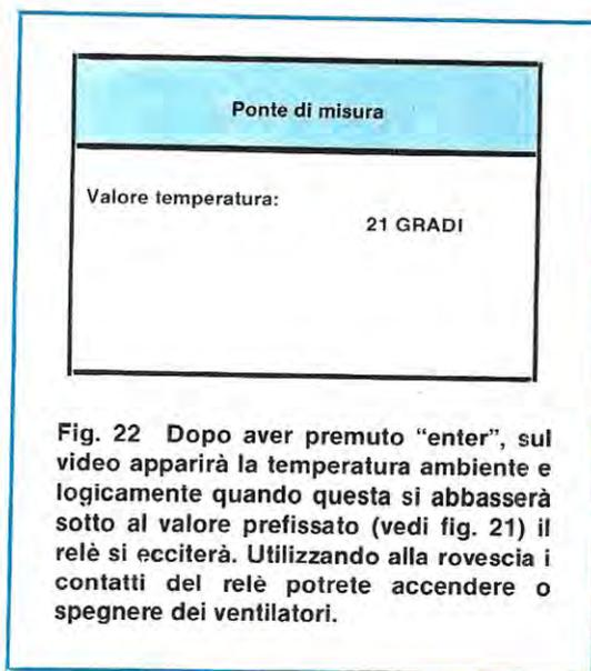
**Fig. 22** Dopo aver premuto "enter", sul video apparirà la temperatura ambiente e logicamente quando questa si abbasserà sotto al valore prefissato (vedi fig. 21) il relè si ecciterà. Utilizzando alla rovescia i contatti del relè potrete accendere o spegnere dei ventilatori.
