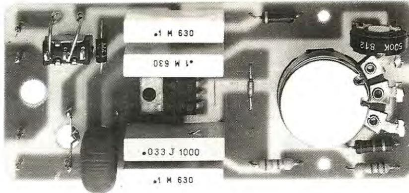
**Fig. 9** In questa foto è meglio visibile il foro in cui risulta inserito il diodo led con i due terminali ripiegati. Ripetiamo ancora una volta che tutto il circuito stampato e relativi componenti sono direttamente collegati alla tensione di rete a 220 volt, quindi non dovrete toccarli se non sarete ben isolati da terra.
