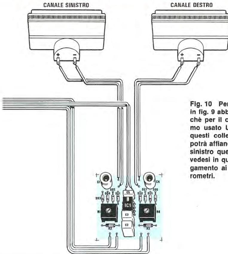
**Fig. 10** Per il collegamento al VU-Meter, in fig. 9 abbiamo riportato solo 4 fili perchè per il collegamento di Massa abbiamo usato UN SOLO filo; chi eseguisse questi collegamenti con piattine bifilari potrà affiancare ai fili del canale destro e sinistro quello collegato a massa, come vedesi in questo disegno. Si noti il collegamento ai due strumentini microampereometri.
