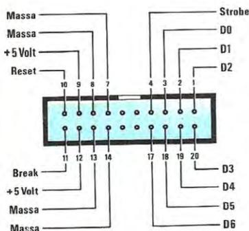
**Fig. 2** Sui pin del connettore da collegare al computer (vedi nella foto in alto il connettore di sinistra), dovrete entrare con le tensioni ed i segnali indicati nel disegno. Pertanto, se sul connettore di uscita del vostro computer le tensioni e i segnali risultassero disposti in modo diverso, dovrete farli collimare invertendo i fili della piattina di collegamento.
