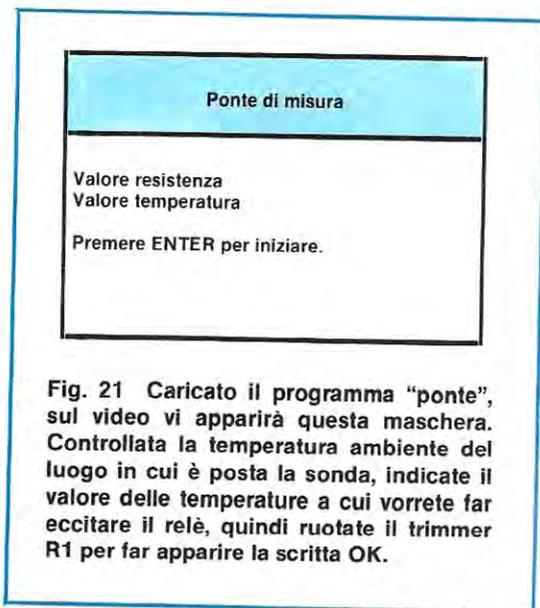
**Fig. 21** Caricato il programma "ponte", sul video vi apparirà questa maschera. Controllata la temperatura ambiente del luogo in cui è posta la sonda, indicate il valore delle temperature a cui vorrete far eccitare il relè, quindi ruotate il trimmer R1 per far apparire la scritta OK.
