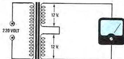
**Fig. 4** Per capire come si possa separare da un segnale S + D il solo segnale D sfruttando la fase, potremo fare un semplice esperimento, ponendo in serie due avvolgimenti da 12 volt prelevati dal secondario di un normale trasformatore di alimentazione.
