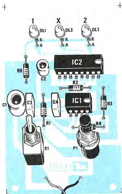
Fig. 3 Di lato lo schema pratico di montaggio del circuito, che speriamo possa assicurarvi un buon 13. Nell'inserire i diodi led nei due fori posti in alto, ricordatevi che il terminale più lungo A andrà rivolto verso l'integrato IC2.
