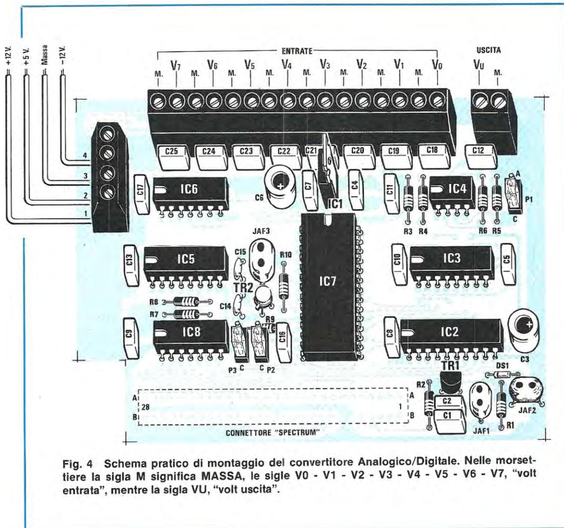
Fig. 4 Schema pratico di montaggio del convertitore Analogico/Digitale. Nelle morsettiere la sigla M significa MASSA, le sigle V0 - V1 - V2 - V3 - V4 - V5 - V6 - V7, "volt entrata", mentre la sigla VU, "volt uscita".
