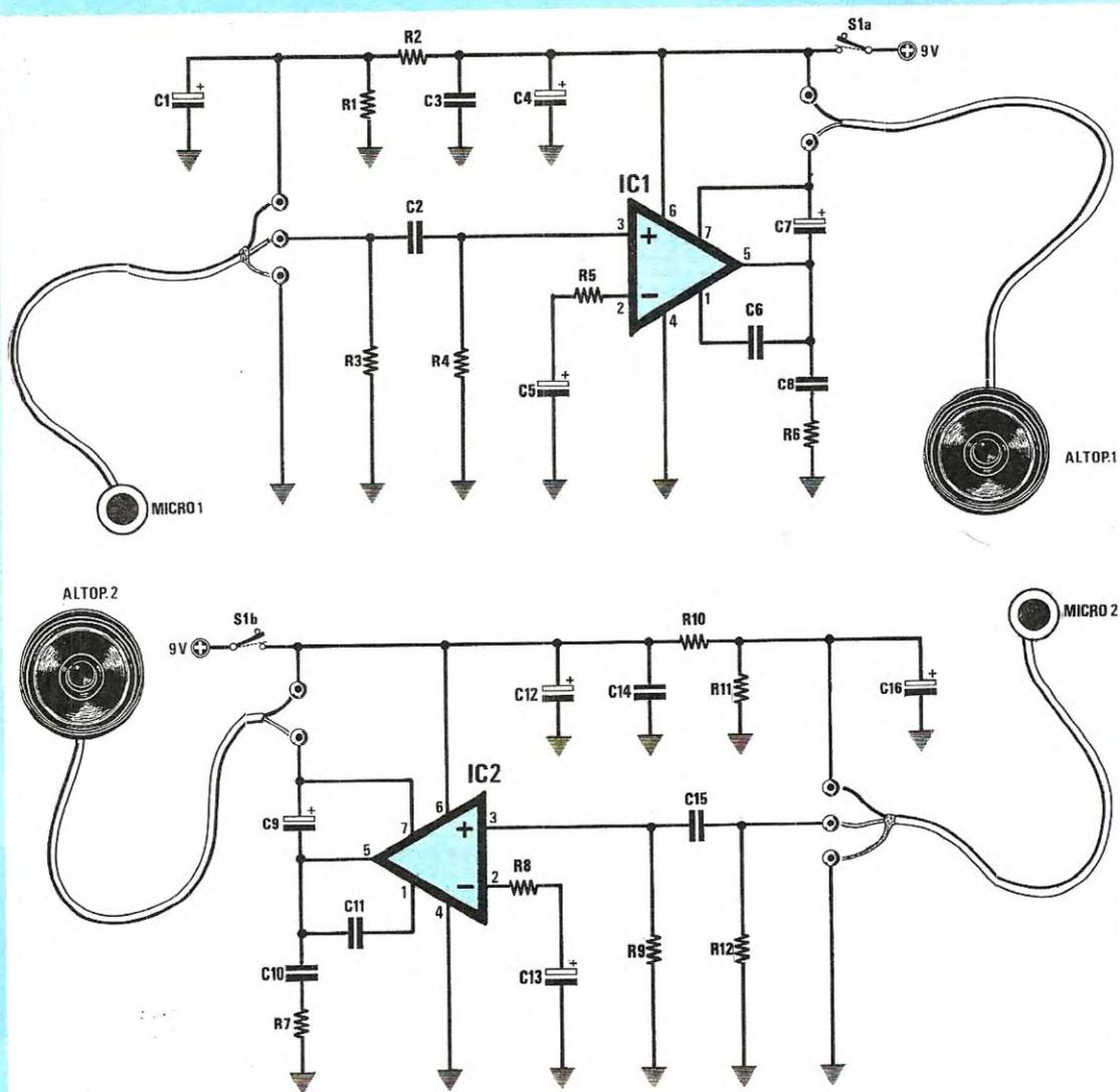
Fig. 1 Schema elettrico dell'amplificatore per casco da motociclista.
