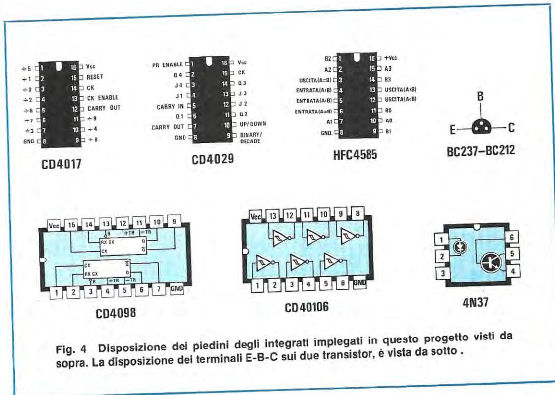
Fig. 4 Disposizione dei piedini degli integrati impiegati in questo progetto visti da sopra. La disposizione dei terminali E-B-C sui due transistor, è vista da sotto.
