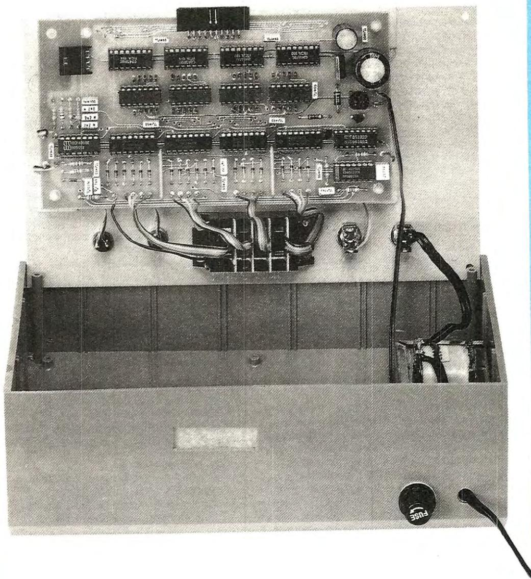
**Fig. 15** Tutto il progetto andrà racchiuso entro un mobile plastico a forma di leggio, provvisto frontalmente di un pannello in alluminio già forato e serigrafato (vedi figura pubblicata ad inizio articolo). Sulla parte destra del mobile fisserete il trasformatore di alimentazione e accanto ad esso il fusibile di protezione. Per fissare il circuito LX.764 sul retro del pannello di alluminio utilizzerete dei distanziatori plastici provvisti di basi autoadesive.
