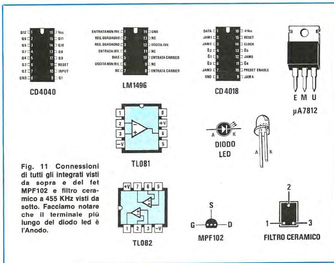
Fig. 11 Connessioni di tutti gli integrati visti da sopra e del fet MPF102 e filtro ceramico a 455 KHz visti da sotto. Facciamo notare che il terminale più lungo del diodo led è l'Anodo.
