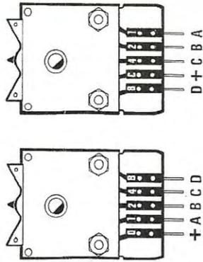
Fig. 8 Non dimenticatevi che sulle cinque piste in rame dei commutatori binari le connessioni non sempre risultano disposte nello stesso ordine, pertanto assumete come riferimento i numeri 1-2-4-8 e il terminale indicato  $\oplus$ , oppure C, o 0.
