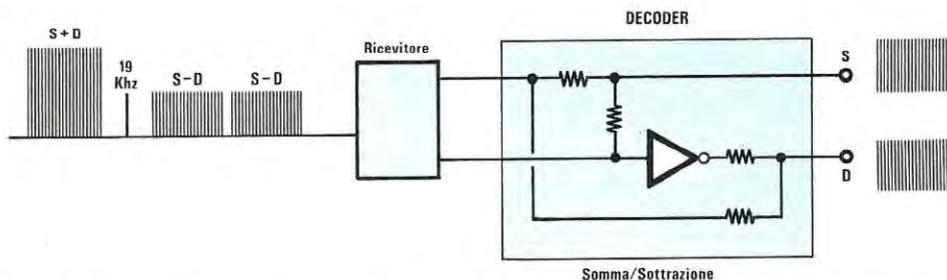
Fig. 2 Il Decoder presente in un qualsiasi ricevitore stereo svolgerà l'operazione inversa, cioè sommerà in fase il segnale  $S + D$  con il segnale  $S - D$  e ne ricaverà il solo segnale del canale SINISTRO; successivamente sfaserà di 180 gradi il segnale  $S - D$  e lo miscelerà al segnale  $S + D$ , ricavando da tale operazione il solo segnale del canale DESTRO.
