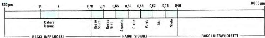
**Fig. 2** Se consideriamo la porzione di gamma dei raggi infrarossi che va dai 600 agli 0,78 micron, scopriamo che il corpo umano emette radiazioni comprese tra i 14 e i 7 micron. Dopo gli infrarossi incontriamo i raggi visibili e, dopo la massima frequenza (colore viola), la gamma degli ultravioletti.
