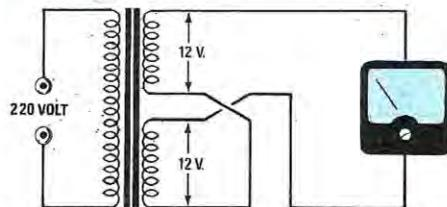
**Fig. 5** Se i due avvolgimenti risultano in "fase" (vedi fig. 4), in uscita otterremo una tensione di 24 volt, se invece risultano "sfasati" (vedi fig. 5) in uscita otterremo 0 volt, o la differenza che potrebbe esistere tra i due avvolgimenti.
