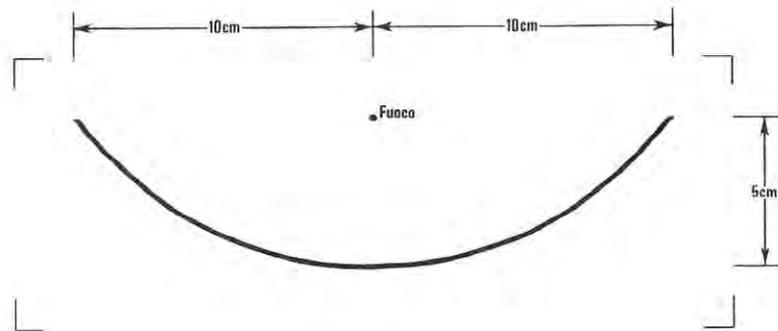
**Fig. 16** Per costruire un semplice riflettore prendete un lamierino di ottone o alluminio lungo 18 cm. circa e alto 7 - 8 cm. e ripiegate lo seguendo la sagoma riportata in figura. Ogni quadrato riportato nel disegno risulta di 1 centimetro per lato. Il "fuoco" di questo riflettore si trova a circa 5 cm.
