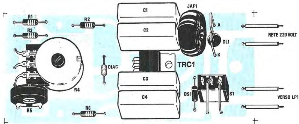
**Fig. 5** Schema pratico di montaggio del varilight. Dopo aver fissato l'interruttore S1 ed il potenziometro R4 sul circuito stampato, ne dovrete collegare i terminali alle piste interessate, come vedesi chiaramente in questo disegno. Si noti come vengono fissati i terminali del diodo led sulle due piste siglate A e K.
