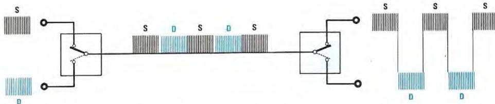
Fig. 3 Nel nostro Encoder per ricavare tutti i segnali  $S + D$  e  $S - D$  abbiamo utilizzato un integrato Miscelatore-Bilanciato che, automaticamente, sopprime oltre alla sottoportante dei 38 KHz, qualsiasi altra frequenza spuria, con tutti i vantaggi che ne derivano. In passato, per ottenere queste funzioni si utilizzavano dei normali commutatori elettronici.
