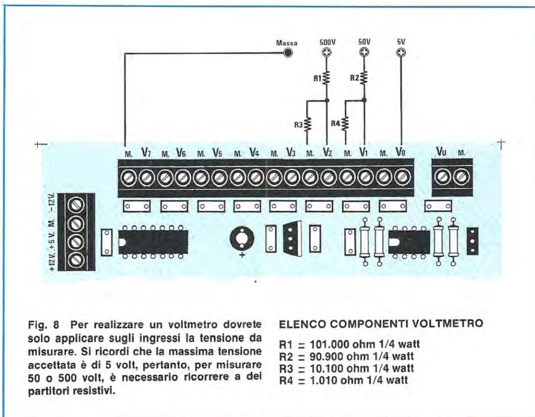
**Fig. 8** Per realizzare un voltmetro dovrete solo applicare sugli ingressi la tensione da misurare. Si ricordi che la massima tensione accettata è di 5 volt, pertanto, per misurare 50 o 500 volt, è necessario ricorrere a dei partitori resistivi.
