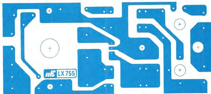
**Fig. 4** Disegno a grandezza naturale del circuito stampato siglato LX.755. Facciamo presente che il disegno del circuito stampato viene riportato sulla rivista solo se non risulta a fori metallizzati e non presenta eccessive difficoltà nella riproduzione.
