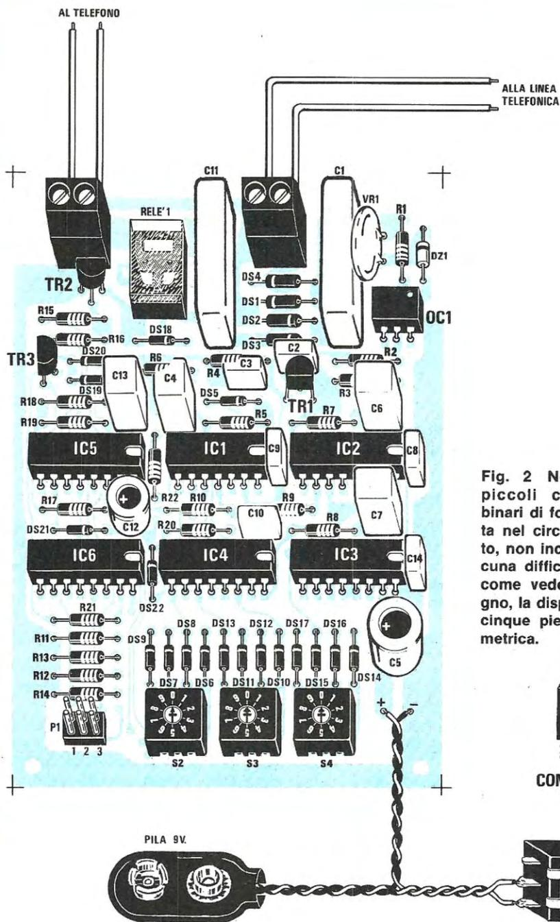
Fig. 2 Nell'inserire i piccoli commutatori binari di forma quadrata nel circuito stampato, non incontrerete alcuna difficoltà, perchè, come vedesi nel disegno, la disposizione dei cinque piedini è asimmetrica.
