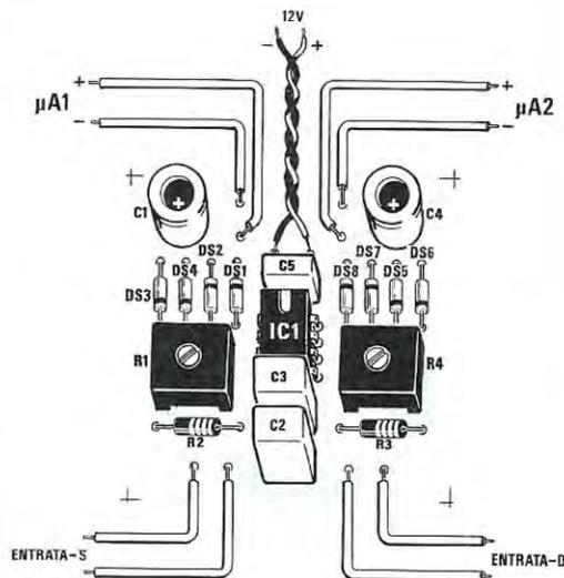
**Fig. 9** Schema pratico dell'encoder descritto nell'articolo. Si notino i cavetti schermati utilizzati per i collegamenti ai due potenziometri e alle due prese femmina jack d'ingresso. Quattro dei fili visibili sulla sinistra andranno a congiungersi al VU-Meter e due al secondario dei 15 volt del trasformatore toroidale. Sulla destra la foto di un prototipo.
