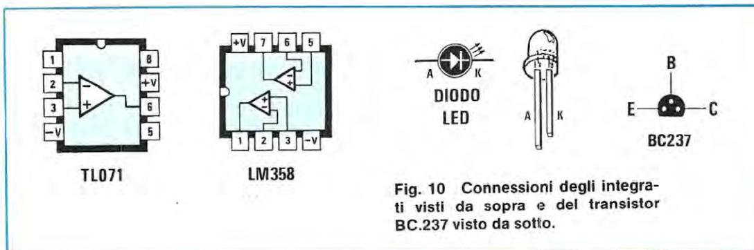
**Fig. 10** Connessioni degli integrati visti da sopra e del transistor BC.237 visto da sotto.
