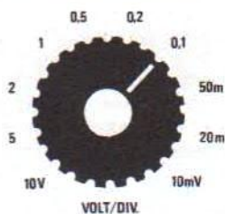
Fig. 18 Ruotando la manopola dell'oscilloscopio nella posizione 0,1 volt \times divisione, sulla scala verticale avremo per quadretto la stessa corrente riportata sui commutatori.
