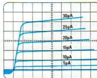
Fig. 41 Poiché la spaziatura delle 6 tracce è legata al «guadagno» del transistor, abbiamo a disposizione ancora la portata x5 e, se ciò non bastasse, potremo passare a 10 - 100 microamper o a 1 - 10 mA.
