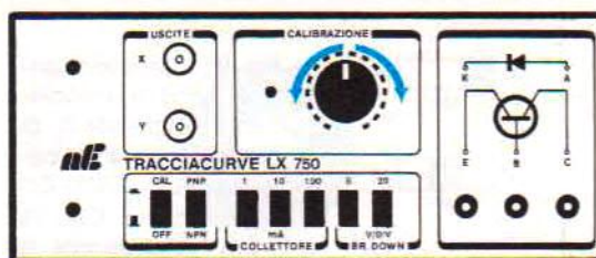
Fig. 24 Dopo aver premuto il pulsante CALIBRAZIONE, dovreste ruotare la manopola presente sul pannello frontale, in modo da ottenere una traccia come visibile in fig. 25.
