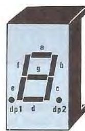
Fig. 14 Connessioni dei due display richiesti per il circuito LX.891. Per queste connessioni non dovrete preoccuparvi, perchè i fori già presenti sul circuito stampato non vi permetteranno di collegarle in senso opposto.
