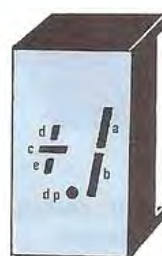
Fig. 14 Connessioni dei due display richiesti per il circuito LX.891. Per queste connessioni non dovrete preoccuparvi, perchè i fori già presenti sul circuito stampato non vi permetteranno di collegarle in senso opposto.
