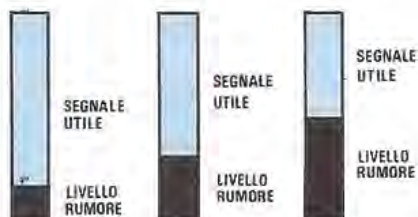
Fig.228 Un rapporto Segnale/Rumore molto alto, significa che sulla totale ampiezza del segnale preamplificato è disponibile un maggior livello di "segnale utile" con un basso livello di rumore.
