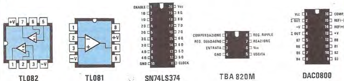
Fig.5 A sinistra, lo schema elettrico del sintetizzatore vocale-musicale e qui sopra le connessioni degli integrati visti da sopra. Nella presa "Entrata Altop." inserirete i due fili che vanno all'altoparlante del computer, in quella in basso, indicata "Uscita Altop." l'altoparlante del computer, mentre dall'Uscita BF potrete prelevare il segnale da applicare ad un qualsiasi amplificatore BF.
