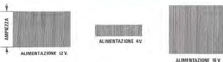
Fig. 5 Se verificaste con un oscilloscopio l'ampiezza di un segnale di Alta Frequenza erogata da un trasmettitore, alimentato con una tensione di 12 volt, potreste ottenere un segnale come visibile a sinistra. Abbassando la tensione a 4 volt, l'ampiezza di tale segnale si ridurrà, mentre alzandola a 16 volt questa ampiezza aumenterà rispetto a quella dei 12 volt.
