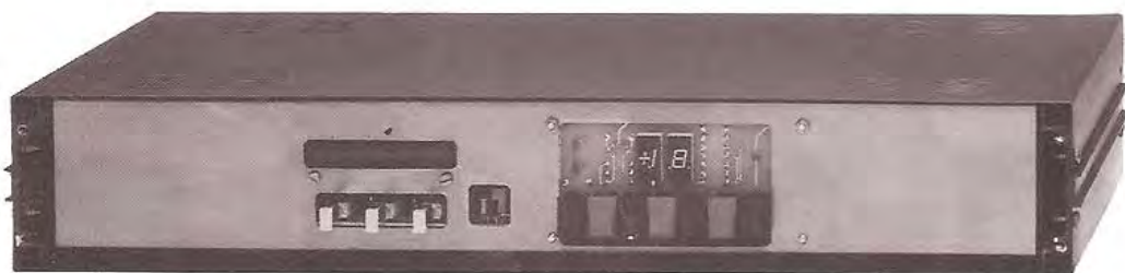
Fig.17 Sul contropannello frontale di tale mobile fisserete il circuito stampato della pulsantiera LX.891 e della barra a diodi led LX.891/B, utilizzando gli appositi distanziatori.
