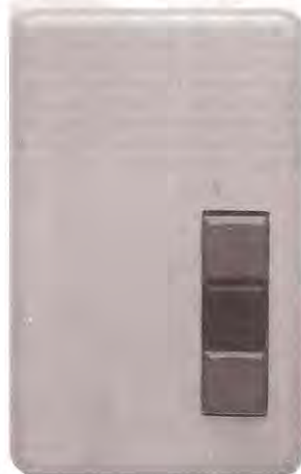
Fig.23 Coperchio del telecomando già forato per far fuoriuscire i tre pulsanti di comando. Nota: se non vi interessa cambiare canale a distanza, potrete anche non richiedere questo telecomando.
