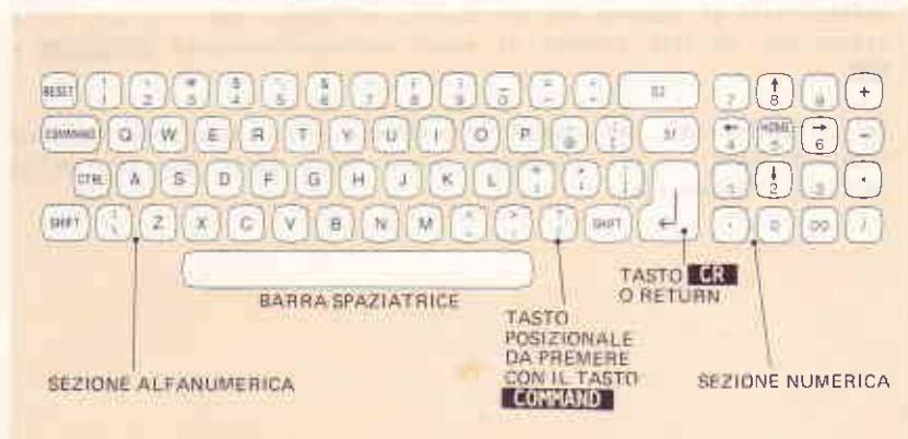
Figura 2-1 la versione USA-ASCII della tastiera dell'M20
